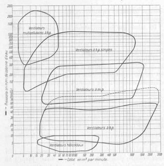
Fig. 1. — Diagrame des ventilateurs centrifuges à basse, moyenne et haute pression.
