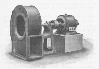
Fig. 6. — Ventilateur centrifuge Sulzer à moyenne pression pour attaque directe par moteur.
