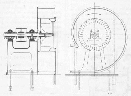
Fig. 10. — Coupe d'un ventilateur centrifugé Sulzer à moyenne pression.
