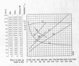
Fig. 41. — Caractéristiques d'un moteur de traction de 80 HP de puissance pendant 6 heures à 1200 t./min. 300 volts. Réduction d'engrenages 4 : 3. Diamètre des roues : 1000 mm.
