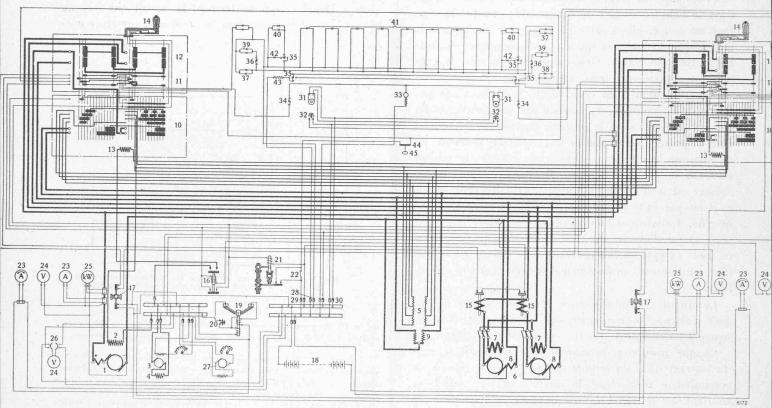
Fig. 12. — Schéma des connexions de l'automotrice.
