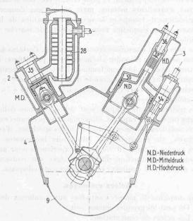
Fig. 8. - Compresseur d'air.
