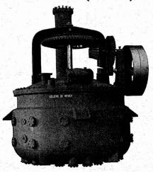
Mélangeur à double fond, diamètre 3500 mm.
