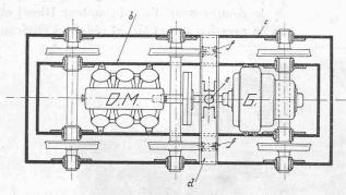
Fig. 4. — Plan schématique du bogie du moteur Diesel.
