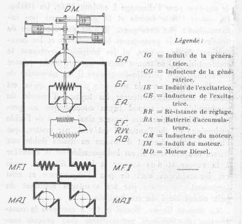
Fig. 2. — Schéma général des connexions de l'automotrice.
