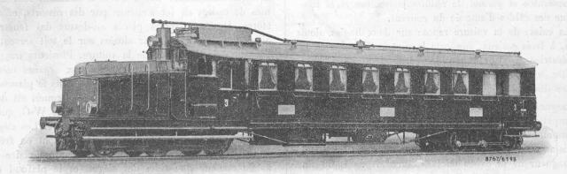
(1 .511) zoró no ach je approvi / Fig. 1. - Automotrice Diesel électrique.
