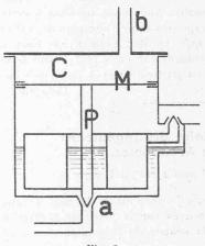
Fig. 2. Schéma de niveau-constant (brevet + 76844).
