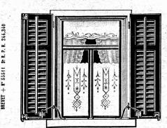
Pour manœuvrer les volets à fenêtres fermées.
