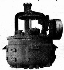
Mélangeur à double fond, diamètre 3500 mm.
