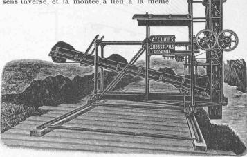
Machine à extraire la tourbe avec panier d'extraction à commande par moteur électrique et transporteur automatique,
