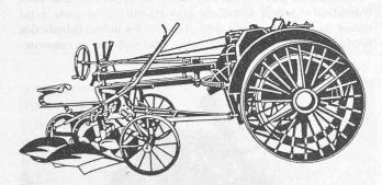
Fig. 1. — Tracteur universel Moline.
