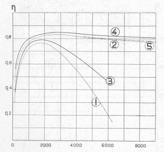
Fig. 8. - Rendements de turbines à action multiples en fonction de k
