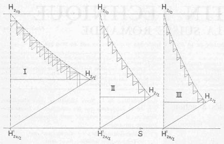
Fig. 6. — Courbes de détente en diagramme chalcurs totales  $H_2$  — entropies S.
