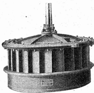
Turbine Francis à axe vertical et chambre d'eau ouverte.
