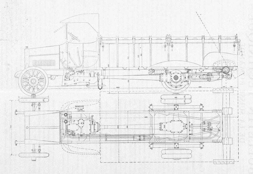
Fig. 1. — Camion automobile pour le transport des ordures ménagères, avec benne baseulante de 6 m³, système Saurer-Ochsner.
