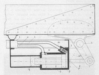
Fig. 7. — Commande du basculement de la benne.
