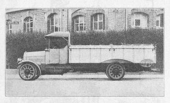
Fig. 2. — Camion automobile pour le transport des ordures ménagères, avec benne basculante de 6 m³, système Saurer-Ochsner.
