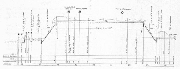
Fig. 1. — Profil en long de la section Usine de Chèvres-lac Léman. — Echelles : longueurs 1 : 50000, hauteurs 1 : 2500.
