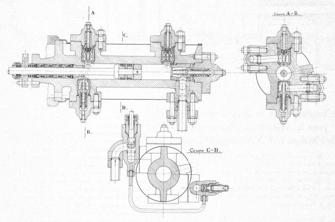
Fig. 81. — Machine frigorifique à acide carbonique.
