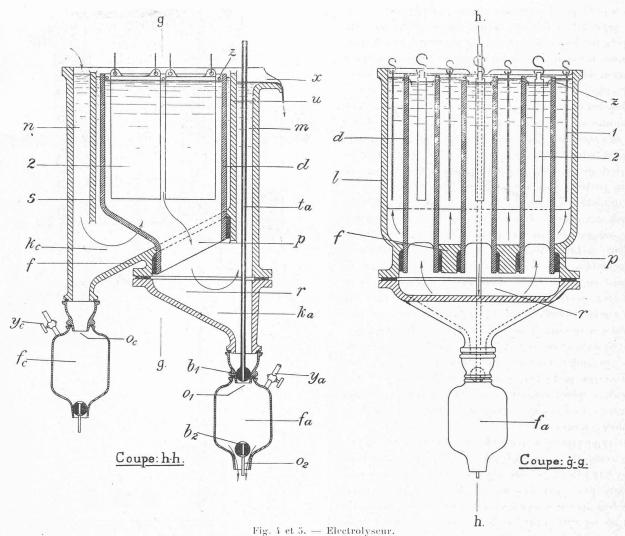
sembler dans le flacon  $f_a$ . Les parties plus légères, celles dont la vitesse de chute dans le bain est inférieure à la vitesse ascendante de ce dernier dans le canal m, sont entraînées par la circulation hors de l'appareil et recueillies sur un filtre. Les dépòts non adhérents aux cathodes tombent sur le fond incliné f et vont se rassembler dans le flacon  $f_a$ .
