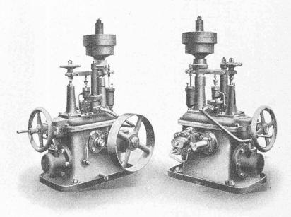
Fig. 59. — Régulateur Nº 1 à huile sous pression. — Energie = 50 kg. m.
