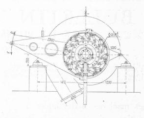
Fig. 56. — Turbine Francis simple de Lauterbrunnen H = 32,5 à 37,5; N = 500 à 600 chev.; n = 400 t/min.
