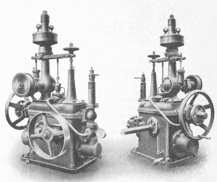
Fig. 60. — Régulateur N° 2 à huile sous pression. — Energie = 400 kg, m.
