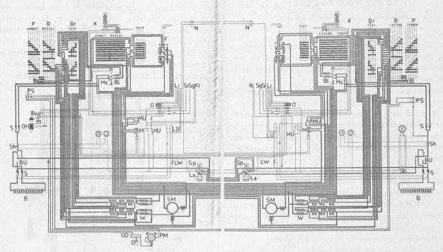
Fig. 3. - Schéma des connexions de l'automotrice à accumulateurs.
