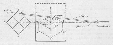
Fig. 5. — Schéma de la bielle à perspective.
