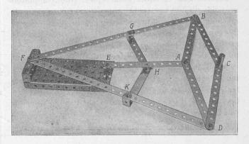
Fig. 7. — Mécanisme de l'inverseur de Peaucellier.
