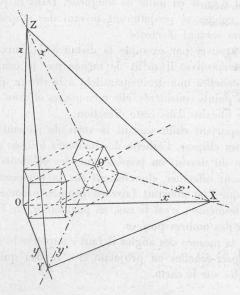
Fig. 1. - Perspective axonométrique d'un cube.
