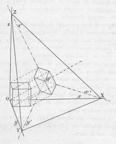
Fig. 1. - Perspective axonométrique d'un cube.
