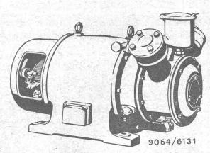
Compresseur commandé par moteur à courant monophasé.
