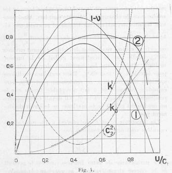
Rendements et courbes caractéristiques en fonction de  $u/c_1$ .
