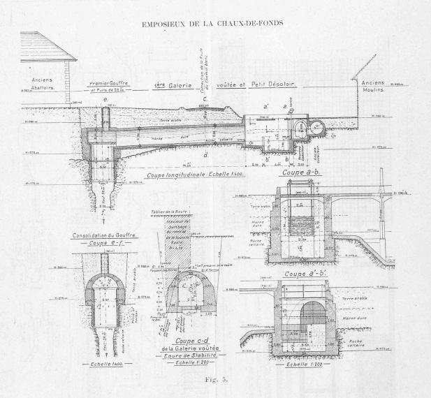
quelle le béton pouvait être soigneusement damé. La couverture de ce puits a la forme d'une voûte en plein cintre de 4 m. 20 d'ouverture. Sur la couverture en béton a été placée une cheminée d'aération surmontée d'un regard en fonte. Cette cheminée servira à l'évacuation des matériaux provenant des nettoyages futurs de la première galerie souterraine.
