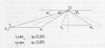
Fig. 3. Diagramme des vitesses d'une turbine élémentuire.
