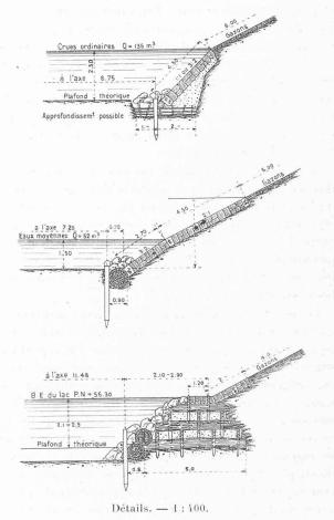
inférieur, 1: 1 sur 2,50 m. de hauteur verticale, avec revêtement en maçonnerie; talus supérieur, 2: 1 jusqu'à 3: 1, gazonné ou ensemensé (fig. 7).
