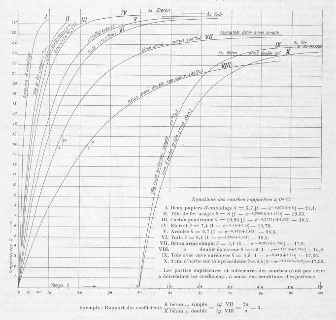
Fig. 6. — Courbes de transmission de chaleur ayant servi à déterminer les coefficients de conductibilité thermique.
