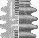
Isolateurs à cannelures pour tensions
