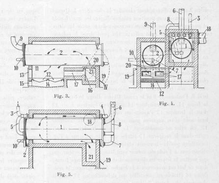
Four à distiller à 2 cylindres, type Sulzer.
