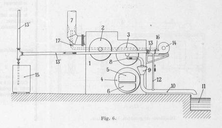
dière 2 et vont directement chauffer la chaudière 1. Quand le levier prend une position intermédiaire, les gaz chauds se partagent d'une manière correspondante entre les deux chemins qui leur sont offerts. On peut donc à volonté régler la température de la chaudière 2.
