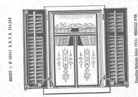
Pour manœuvrer les volets à fenêtres fermées.
