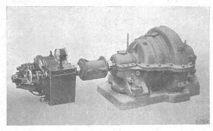
Soufflante à gaz pour 33,8 m³/min. Pression de refoulement 450 mm. colonne d'eau Machine livrée aux Services Industriels de la Ville de Genève. Pression constante.
