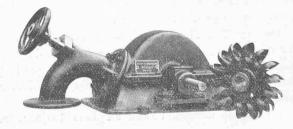
Fig. 47. Turbine Pelton de 200 mm. de diamètre.
