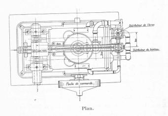
Fig. 46. — Détails du servo-moteur à double action.
