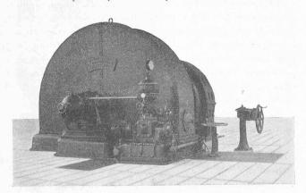
Fig. 21. — Vue générale de la turbine de Fully, côté régulateur, H=1650 mètres ;  $N=3000~{\rm HP}$  ;  $n=500~{\rm t./min}$ .
