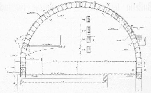
Fig. 20. - Ferme en béton armé.
