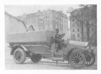
Fig. 9 — Arroseuse automobile
