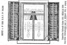
pour manœuvrer les volets à fenêtres fermées.
