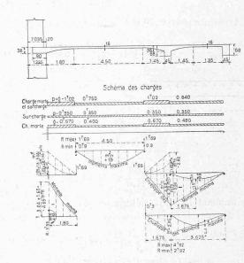
Fig. 11. — Poutraison sur rez-de-chaussée. — Coupe C-D. Epures. — Surchages: 350 kg.
