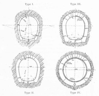
Fig. 9. - Centrale de Ritom. - Profils normaux du souterrain.
