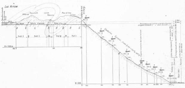
Fig. 7. — Centrale de Ritom. — Profil en long. — Echelle 1:13 750.
