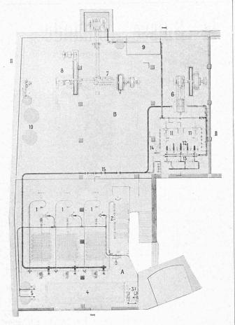
Fig. 2. — Plan de la salle des chaudières et des machines. 1:50.
