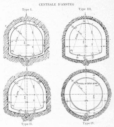
Fig. 5. — Profils-types de la galerie d'amenée.— 1:90
