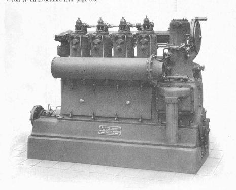
Fig. 66. — Moteur Diesel réversible, type marin.
