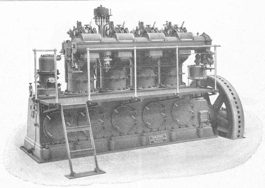
Fig 63. — Moteur Diesel à grande vitesse, à 4 cylindres.
