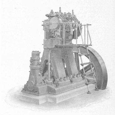
Fig. 64. — Moteur Diesel à vitesse réduite, à 2 cylindres.
