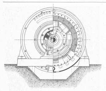
Fig. 28. — Coupe d'un alternateur. — 1:40.
