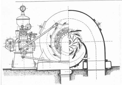
Fig. 23. — Coupe d'une turbine avec vue du régulateur. — 1:40.
