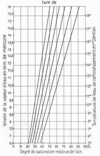
Fig. 12. - Courbes de tension de vapeur.
