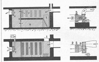
Fig. 7. — Comparaison de la place occupée par une chambre de chauffage en maçonnerie et par un appareil Sendric de même effet.
