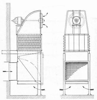
Fig. 16. - Appareil Sendric de chauffage pour fabriques.
