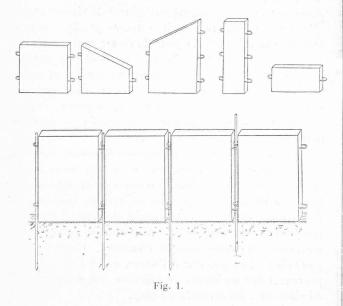
charnière par l'introduction d'une barre de fer rond de 20 à 25 mm. de diamètre, laquelle est ensuite enfoncée dans le sol à une profondeur variant de 0,30 m. à 1,50 m.
