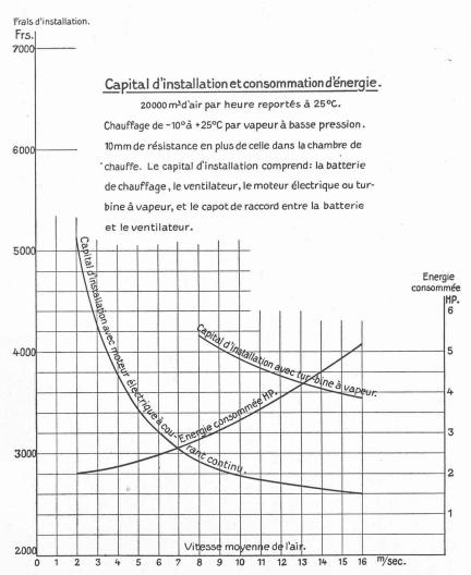
Fig. 3. — Frais d'installation et consommation d'énergie d'un appareil Sendric, pour différentes vitesses de l'air.
