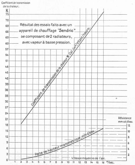
Ftg. 2. — Résultats obtenus avec un appareil Sendric composé de 2 radiateurs chauffés à la vapeur à basse pression.
