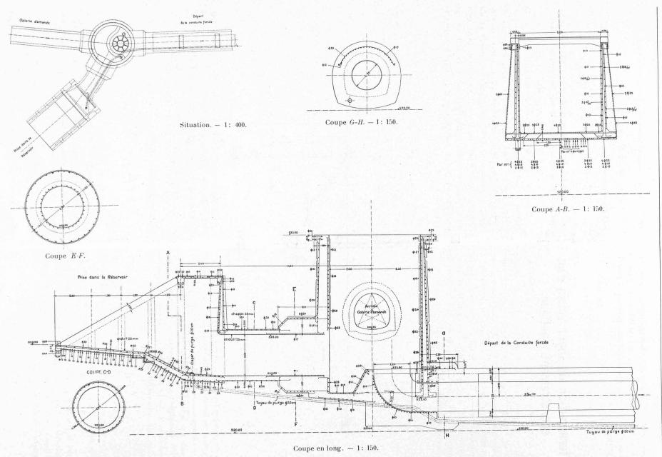
Fig. 13. — Chambre de mise en charge.
