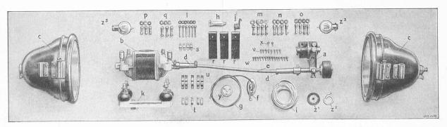
Système Ch. Dufaux fils d'éclairage électrique pour automobiles.
